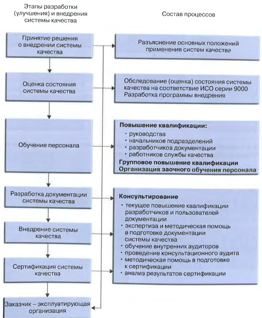
Рис. 2. Основные этапы разработки (совершенствования), внедрения и сертификации системы качества для постоянного улучшения существующих и создания новых ИИС ПХГ
